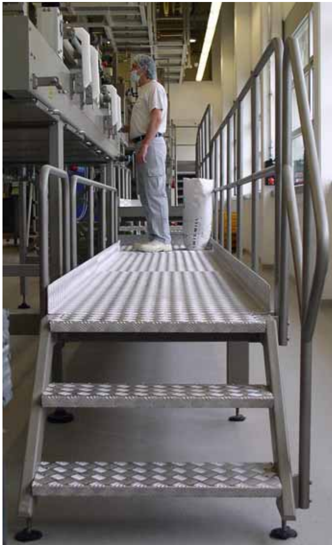
Fig. 4 La plateforme de contrôle le long de l'installation de transformation est sécurisée des deux côtés par un garde-corps. Cette sécurisation est obligatoire, car la hauteur de chute dépasse 500 mm.
