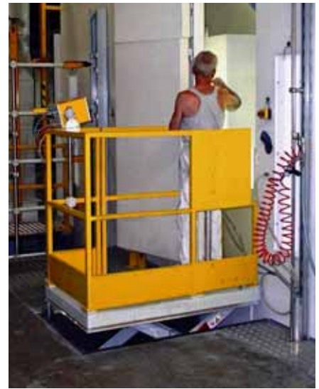
Fig. 5 Cette plateforme élévatrice a une hauteur maximale de levage de 1 m. Le garde-corps protège l'opérateur des chutes (par ex. en cas de faux pas en arrière) quelle que soit la hauteur du pont. Il arrive que les conditions de travail rendent obligatoire l'installation d'un garde-corps à une hauteur de chute inférieure à 500 mm.
