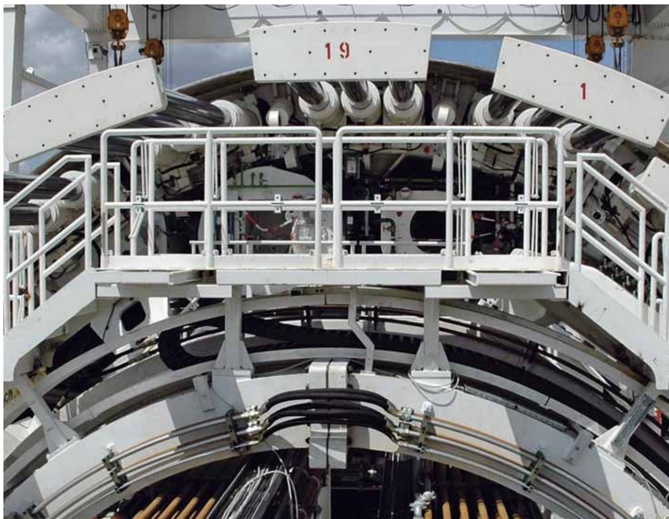
Fig. 23 Garde-corps en plusieurs parties. L'espace libre entre les différentes parties du garde-corps est au minimum de 75 mm et au maximum de 120 mm. On évite ainsi tout coincement involontaire de la main dans ces espaces.
