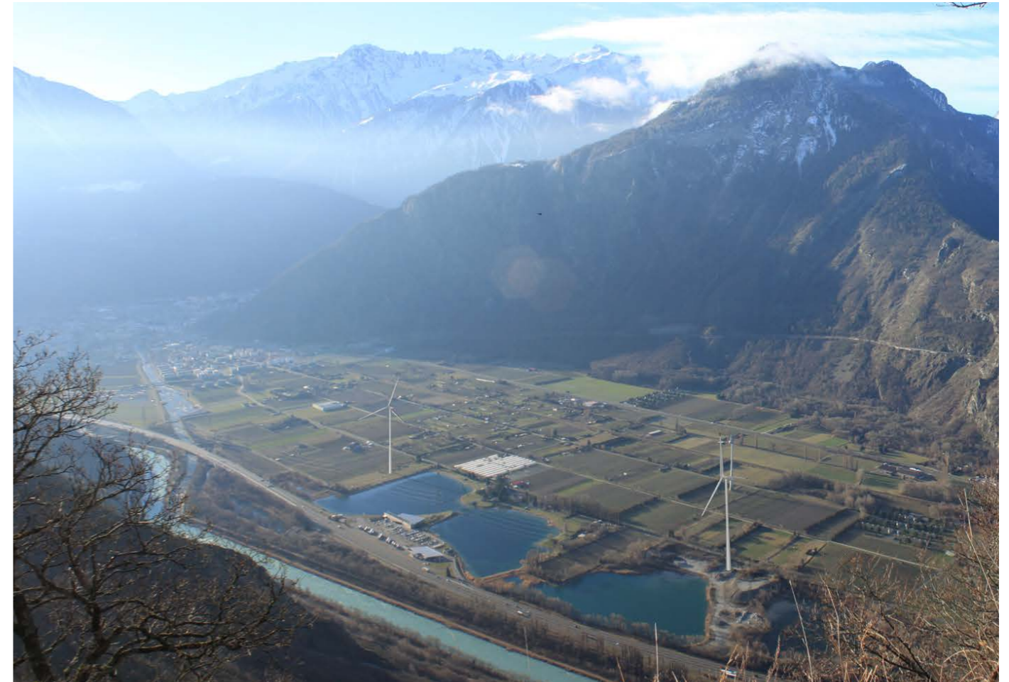
4. Superposition de la photographie et de l'image Google Earth sur Adobe Photoshop, mise à l'échelle, ajout des éoliennes et réglages des paramètres (luminosité, contraste, flou) pour un rendu aussi fidèle que possible.
