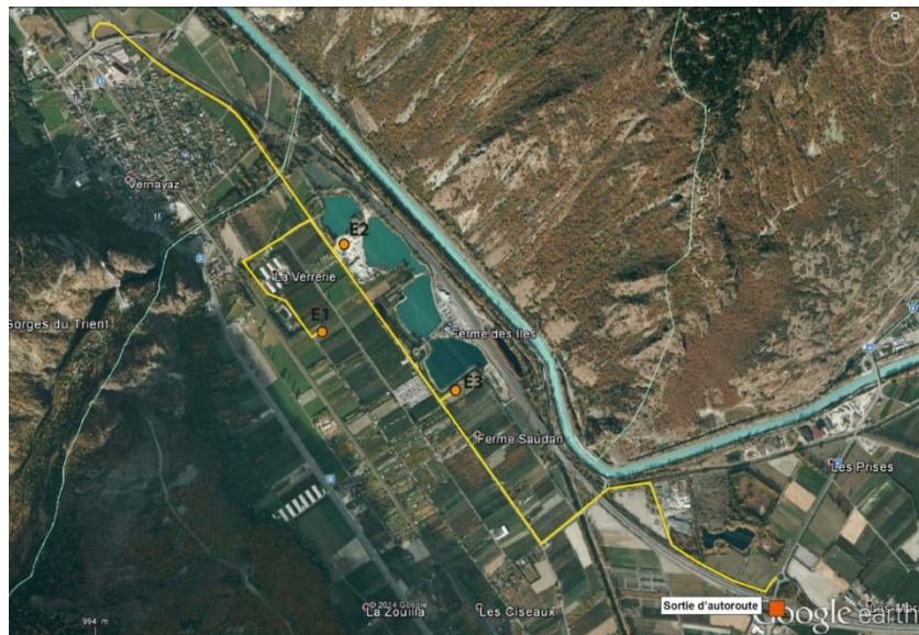
Figure 21 : Tracé pour l'accès des véhicules de chantier conventionnels. Ces routes sont déjà fréquemment utilisées par des camions de 40 to pour le transport de matériaux d'excavation et débris de construction.
