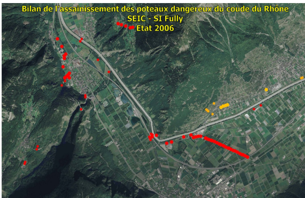
Figure 52 : Pylônes et lignes de moyenne-tension dangereux mis sous terre et assainis (état 2006) pour le Hibou Grand-duc appartenant au réseau SEIC SA et SI Fully, identifiés par la station ornithologique suisse dans le cadre de l'implantation des éoliennes-test de Collonges et de Martigny.
