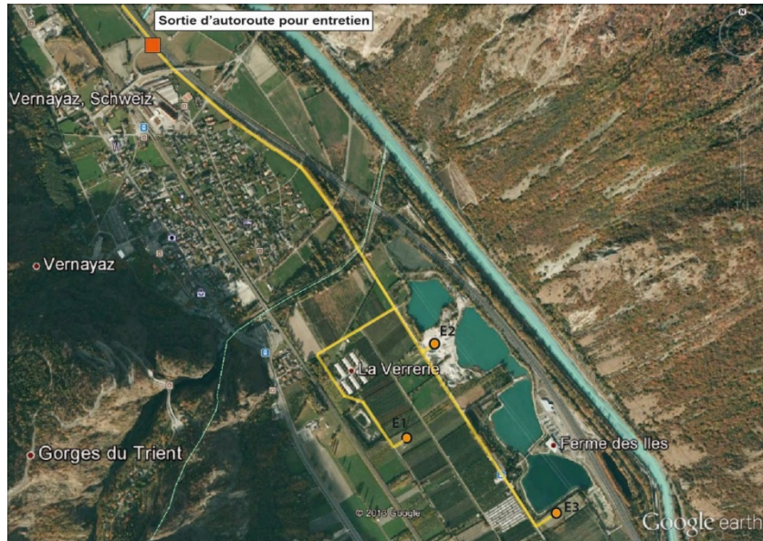
Figure 20 : Tracé pour les convois transportant les pales et autres éléments de dimensions exceptionnelles.
