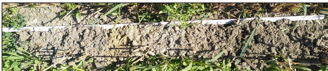
Photo n° 2. Sondage à la tarière à l'emplacement de l'éolienne E3.
