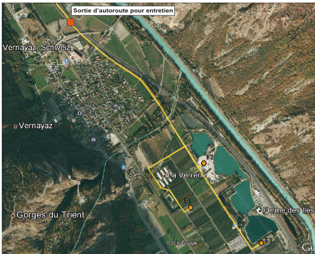
Figure 2 : Tracé pour l'accès des convois exceptionnels. La sortie autoroutière d'entretien du côté de Vernayaz permettra un accès direct et aisé à la route des Iles et aux emplacements des éoliennes E2 Les Sables et E3 Les Iles. Le tracé en direction de l'éolienne E1 montre l'itinéraire utilisé en 2008 pour la construction de l'éolienne-test E1 Mont d'Ottan.
